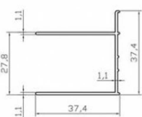
K4427 DUVAR DİKME PROFİLİ 0.340 Kg/m
